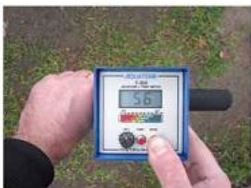
土壤温湿度计T-350是专利设计，可以有效全天候监控湿度和温度。测量仪精度高，可数秒内显示结果，可用于各种土壤测量，不受温度、pH和溶解盐或金属离子影响。因根据精密测量原理设计，测量在屏蔽、高频条件下进行容积测量。
