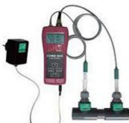
Flow Control 5000 可以在线监控所有类型的园艺、施肥等的温度、pH值和电导率，其可持续测量管路或支路中流体的实时 EC 和 pH 值。流体流量过大或超过所设流量阈值时，会有声音提示，以确保植物培养管理安全可靠，避免了施肥过量或施肥不足的风险。外设的警报系统，如指示灯或警报铃可以与外接继电器相连。LCD 屏可即时显示温度、pH 和 EC 值。该分析仪使用方便、可挂在墙上，软管接头套件使得探针安装非常便捷，只需在校准或更换时移除。
