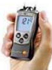
材料湿度计包括保护套、电池和校准规程。材料湿度以重量百分比显示，木材和建筑物配有存储材料特性曲线。精确测量山毛榉、云杉、落叶松、橡树、松树、枫树水分，存储有相应特征曲线。
