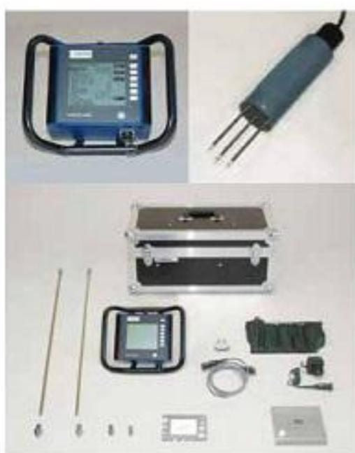
贯入阻抗反应了土壤能力，是测量根有多容易穿透土壤。这在农业、农村以及城市工程技术领域非常重要。贯入阻抗是一个机械变量，基于多个变量，依赖于特定土壤的矿物颗粒，例如复合物的湿度、密度和强度。贯入阻力通过配备数据采集仪的电透度仪多次进行测量，数据于数据采集仪中存储和分析。
