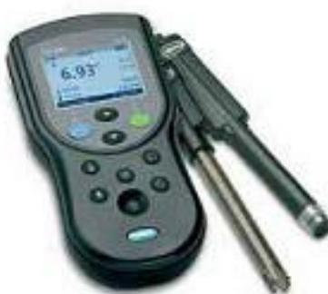
高品质数显HQd性能稳定，设计优化，配备有多种实用附件和智能电极。HQd与众不同在于配备了最新研发的智能INTELICAL电极，所有相关特征参数均以数字化存储。数字智能INTELICAL电极具有自动识别功能。校准数据储存于INTELICAL智能电极中。可编程设置控制间隔。操作更简捷，性能更可靠。检测结果瞬时可得。
