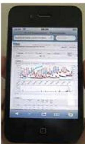
当超过特定温度传感器设定值时，T-Wane天气工作站可同时向8个手机号码发送SMS短信。这些阈值可在任意时间通过密码保护的互联网登陆进行设置。温度报警功能可以应用于多个领域，如可实现果园、土豆场、葡萄园降霜预警。可设置若干预警阈值。除了霜冻预警，还可用与储藏室温度预警，亦可用于多通道培养系统领域。
