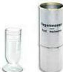
该雨量计是为降低高温天气下的蒸汽损失特别研发。降水量通过内量筒测量,刻度指示0~25mm。刻度指示了L/m² 土壤降水量 空气交换最小:
