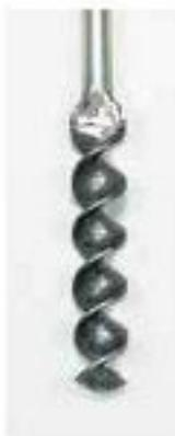
spiral 螺旋钻的操作类似于螺丝刀，不会切掉土壤。改手钻通常用于穿透硬层，如砖层、白垩和石灰等。狭有的螺旋钻将石头压到旁边，利用特殊顶部钻出孔。当给更大钻阻力时，钻出垂直钻孔。
