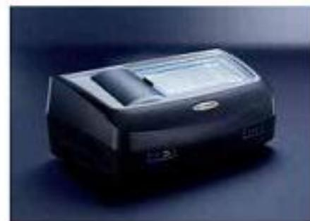
LASA AGRO 3900是一款理想的土壤和水分析用设备，用于实验室专业分析。新型2D条码（二维码）详细记录着试剂批次号码以及过期日期。利用条码阅读器，通过验证的旋转10次测量，LASA AGRO 3900立刻提取比色皿的所有信息。批次号、过期日期与测量结果一起保存。可通过获取的光谱（320-1100）、浓度、吸收以及浑浊度测量对用户界定的线性和非线性校准曲线进行编程。不同的比色皿尺寸（10-50mm尺寸）允许仪器进行大量程测量，如饮用水的痕量分析以及高浓度的土壤分析。
