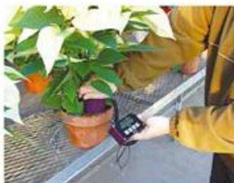
TDR(时域反射计)可以测量土壤剖面的容积含水率。该方法被证实是一款快速、可靠和方便的土壤测量方法。两个电极插入到土壤中，发射出电磁波。反射波速度与土壤水含量正相关。便携式TDR可以测量不同土层水含量。LCD界面提供两种模式：容积水含量模式和相对水含量模式(灌溉管理)。干/湿容积水含量设置可以测试编程，可达5种不同地点或土壤类型。已经出厂设置5种矿物土壤默认值(以永久萎焉点和田间持水量作为设置点)。
