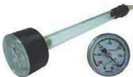
经典方法(真空规)目前仍在广泛使用。土壤干燥后，张力计里的水分通过尖端进入土壤，直至土壤饱和。管内真空度增加，可通过量规则测出。张力测量的常用单位是kPa。
