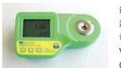
本款为经济型糖度计，易于使用，快速精确。标准ATC(自动温度补偿)。双重温度，低电量报警，自动电源管理，防水设计。显示4种单位：MASS S/W(糖浓度)，VOLAP，Oechsle(德国单位)和KMW(Klosterneuburger Most Weight)
