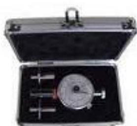
本款仪器可为果实采收的时间提供准确的指导，并对冷藏过程中的成熟进程(果肉软化)进行监控。
