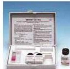
滴定检测盒是全配的塑料箱和所有试剂以及 1 次检测所需附件。结果以 mg/L 直接显示。滴定检测盒包括：
