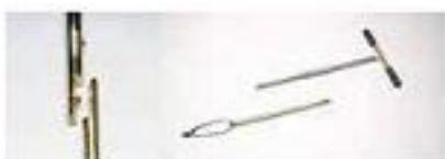
以上所述所有钻均为单钻或双钻。当单钻或双钻不能满足测试深度要求时，可使用刺刀样扩展连杆。使用手钻可轻易钻到8~10m。
