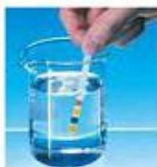
检测棒用来快速、半定量的测量溶液不同的参数。指示检测试纸满足现代检测方法的要求：
