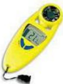
便携式风速计,用以测量实际风速(km/h, mph, m/s 或 knots),记录最大、最小和平均风速,温度测量(°C)和风寒温度。量程:0.2~30m/s;-30~+60°C
