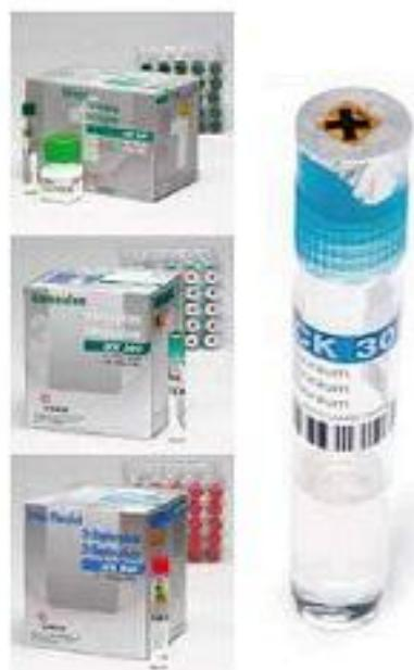
同时使用多功能比色皿用于运输、给量、消解、反应、测量以及处理。
