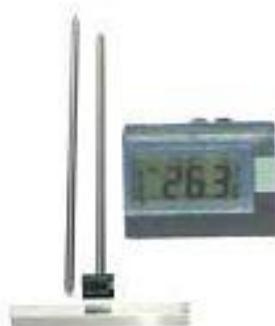
温度探针长 1500 mm, 可延伸到2800 mm, 带显示屏和扶手。有键可从内温(=显示屏温度)和外温(=测量点温度)间转换。尖头探针用于测量储存材料。温度情况持续显示。1500 mm温度探针带显示屏并安有尖头。
