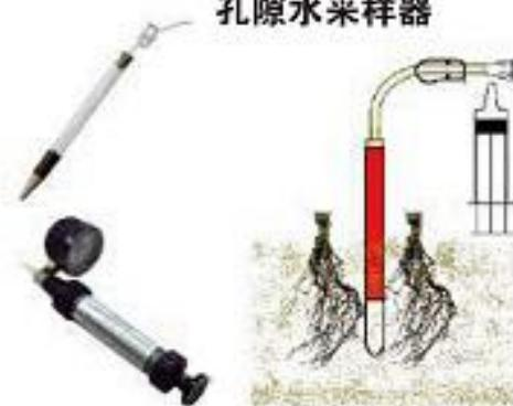
孔隙水采样器可用来营养物分析土壤提取和土壤水采样。
